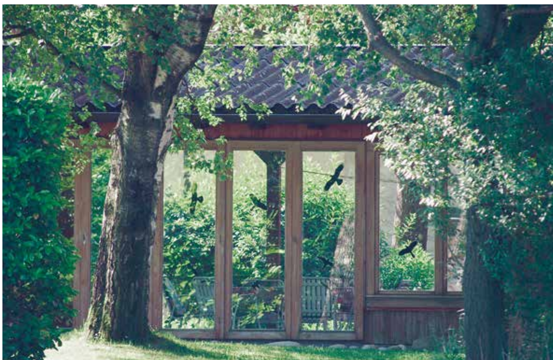
Útulný venkovní prostor. Živé ploty přispívají ke koridorovému efektu vytvářenému skleněnými tabulemi. Siluety dravců na skle značí, že se o problému ví, rozhodně však tento problém neřeší.
