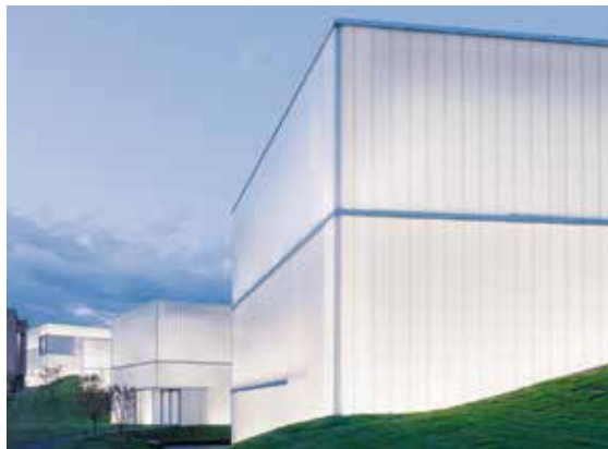
Světlo rozptylující dvojsklo ve dvojitém U profilu využívá denní světlo, výrazně snižuje tepelné ztráty a zajišťuje rovnoměrné osvětlení celé místnosti
